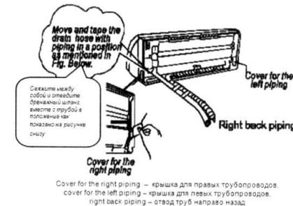
Cover for the right piping - крышка для правых трубопроводов, cover for the left piping - крышка для левых трубопроводов, right back piping - отвод труб направо назад
