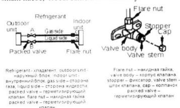
Refrigerant - хладагент, outdoor unit - наружный блок, indoor unit - внутренний блок, gas side - сторона газа, liquid side - сторона жидкости, packed valve - герметизирующий клапан, flare nut - накидная гайка, packed valve - герметизирующий клапан
