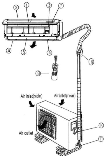
Air inlet (side) - боковой воздухозаборник; Air inlet (rear) - тыльный воздухозаборник; Air outlet - воздуховыпускное отверстие.
