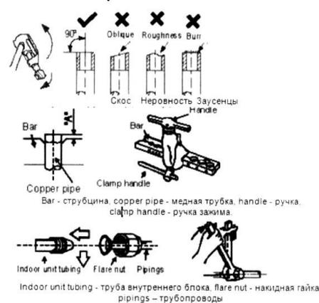
Bar - струбцина, copper pipe - медная трубка, handle - ручка, clamp handle - ручка зажима.
