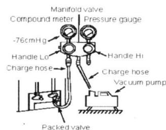
Manifold valve - распределительный клапан, compound meter - индикатор разряжения, pressure gauge - манометр - 76cmHg - 76 см рт. ст., handle Lo - маховичок низкого давления, handle Hi - маховичок высокого давления, charge hose - нагнетательный шланг, vacuum pump - вакуумный насос, packed valve - герметизирующий клапан
