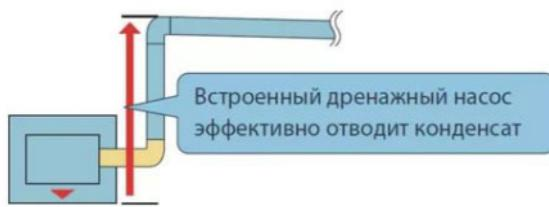
Дренажная помпа для отвода конденсата на высоту до 750 мм
